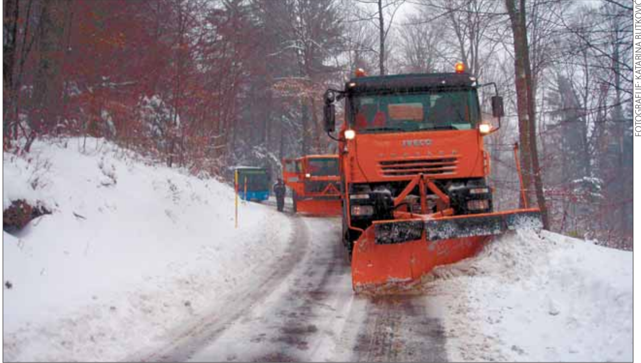
U toploj kabini nije loše, ralica široka četiri metra uspješno baca snijeg u stranu, a posipač baca oko 15 grama soli po kvadratu
