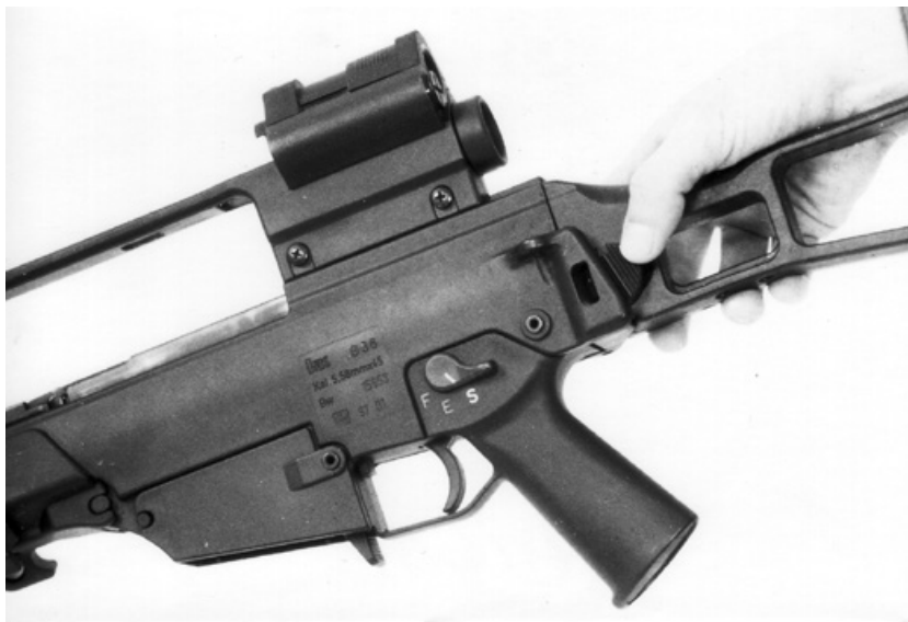
Abb. 66: Riegel eindrücken/Schulterstütze nach rechts ausklappen
