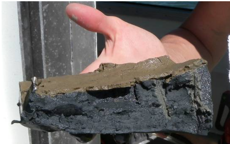
Figur 4-4 Ytsediment tagna under Göta älv, Göteborgsgrenen. Grå homogen postglacial lera. Den översta millimetern är brunare i karaktären och innehåller silt- och sandkorn. Foto: SGI.
