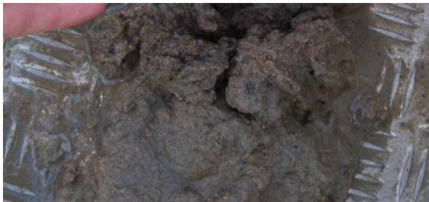
Figur 4-7 Ytsediment i älven ut- anför Dössebacka. Brun sand med växtde- lar. Foto: SGI.
