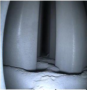
SG器内のスケールおよびスラッジの残存状況 (B-SG 第1管支持板上)
