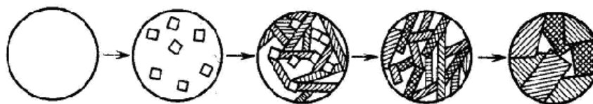
Рис. 17.4. Схема кристаллизации стекла при образовании ситаллов с помощью катализаторов
