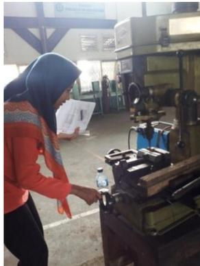
**Gambar 3.28.** Proses *machining* menggunakan mesin frais
