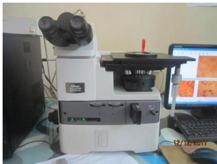
**Gambar 3.39.** Mikroskop untuk pengamatan struktur mikro
