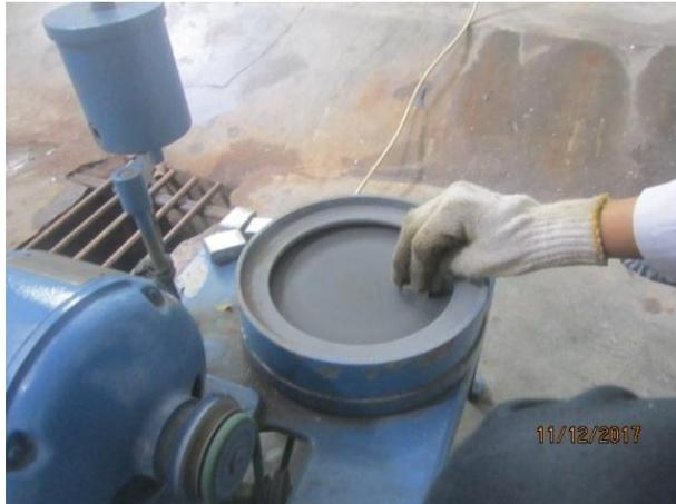
**Gambar 3.38.** Pemolesan Spesimen Metalografi
