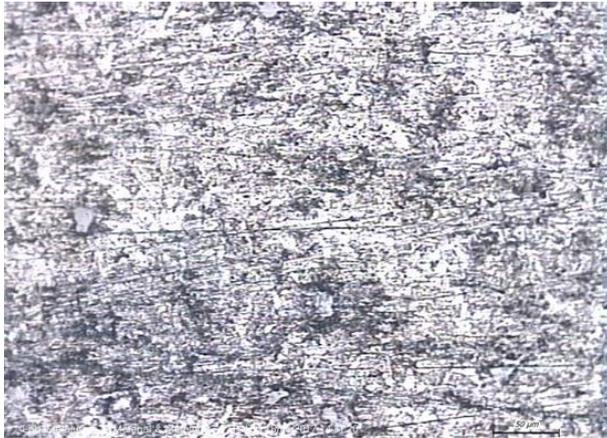
**Gambar 4.4.** Struktur Mikro 80%Al-20%Cu. Pembesaran 200 Kali
