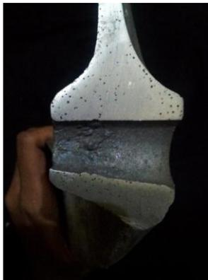
**Gambar 4.9.** Foto Makro Potongan melintang *Propeller* paduan Al-Cu-Mg-Si komposisi I
