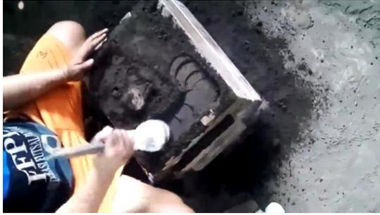
**Gambar 3.17.** Proses penumbukan / Pematatan pasir
