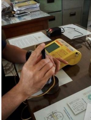
**Gambar 3.25.** Proses Pengujian Kekerasan
