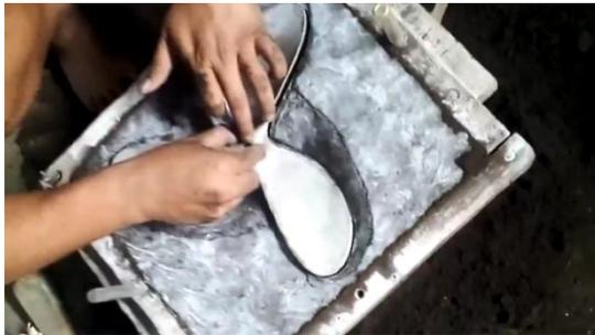
**Gambar 3.18.** Proses pelepasan mal
