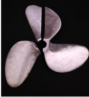
**Gambar 4.6.** Foto Makro *Propeller* paduan Al-Mg tampak belakang
