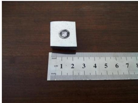
**Gambar 3.24.** Spesimen uji kekerasan
