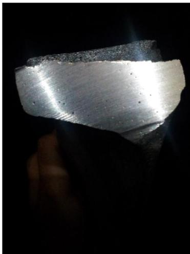
**Gambar 4.12.** Foto Makro Potongan melintang *Propeller* paduan Al-Cu-Mg-Si komposisi IV
