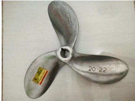
**Gambar 3.9.** Pola Mal Cetakan *Propeller*
