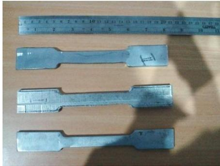
**Gambar 3.29.** Spesimen Uji tarik yang siap diuji
