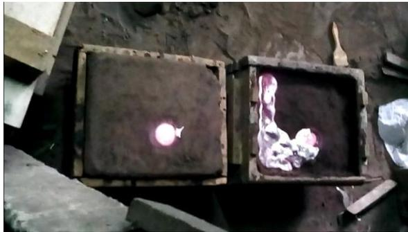
**Gambar 3.19.** Penuangan logam cair kedalam cetakan
