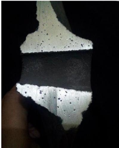
**Gambar 4.10.** Foto Makro Potongan melintang *Propeller* paduan Al-Cu-Mg-Si komposisi II
