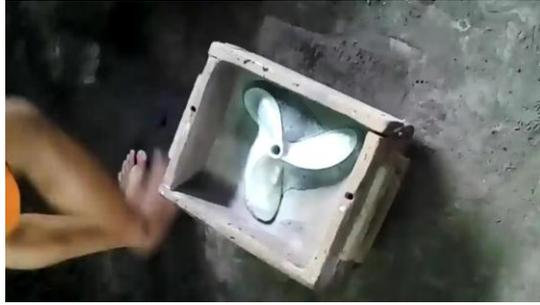
**Gambar 3.15.** Pembentukan Pola *Propeller*
