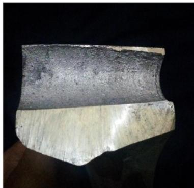
**Gambar 4.13.** Foto Makro Potongan melintang *Propeller* paduan Al-Cu-Mg-Si komposisi V
