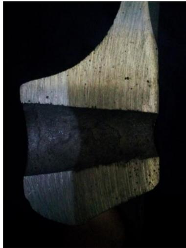
**Gambar 4.11.** Foto Makro Potongan melintang *Propeller* paduan Al-Cu-Mg-Si komposisi III
