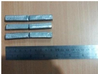
**Gambar 3.34.** Spesimen uji *impact*
