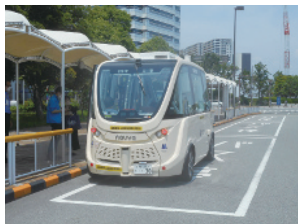
OSAKA METROが技術展会場前でデモンストレーションした自動運転車。車両は前後同形で、どちら向きにも走行できます
