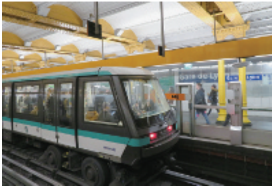
写真-25 ゴム=タイヤ式自動運転のメトロ14号線。1998年に開業し、計画時には「メテオール」(MétéorまたはMETEOR=METro Est-Ouest Rapide:「東西高速メトロ」の意。「流星」météoreの意味も掛けてある)線と呼ばれていた。(2020年1月29日)
