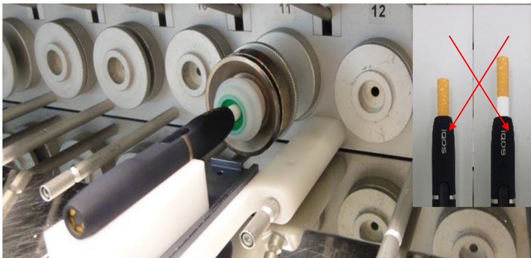
Рисунок 19 – Прокуривание ЭСНТ на курительной машине Cerulean SM450
