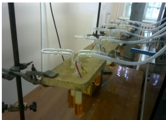
Рисунок 22 – Улавливание карбонильных соединений с помощью барботеров, присоединенных к курительной машине
