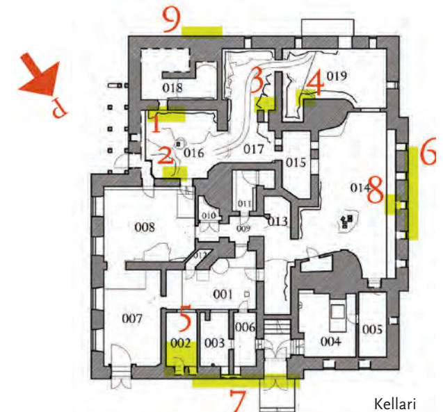
2. Kantava tiilimuri nousee suoraan kallion päältä kellaritilassa 016.
