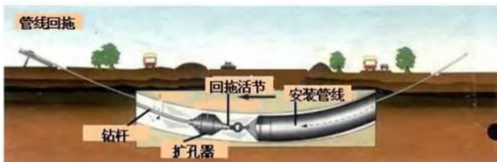
图 3.3.1-6 管线回拖示意图
