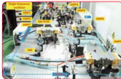
200Hz/5J/2DL激光器原理样机
