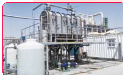
30吨/日二效板式蒸馏海水淡化装置
