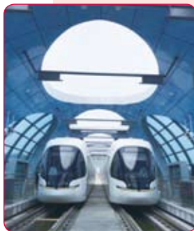
全程无触网超级电容有轨电车
