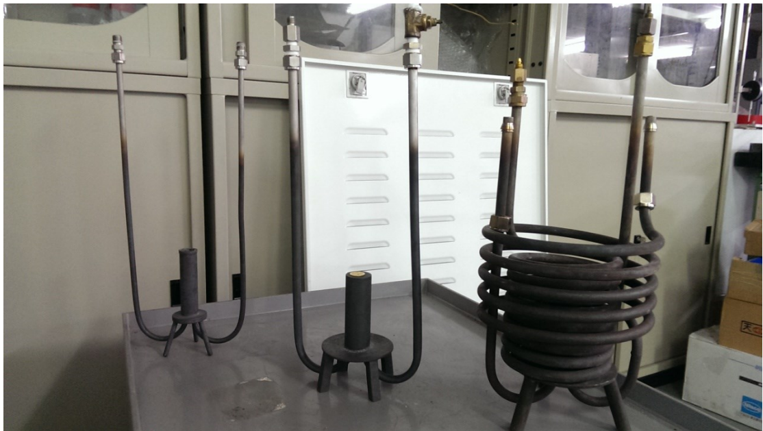
圖十四、自製(鈕扣)電池夾具(左：第一代、中：第二代、右：第三代)
