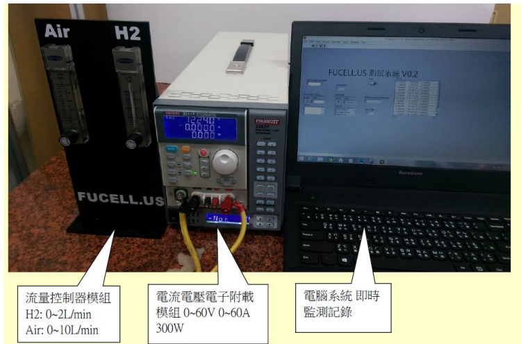
圖六十九、固態氧化物燃料電池測試系統:(左) 電池組暨高溫爐;(右)開放式電池測試系統
