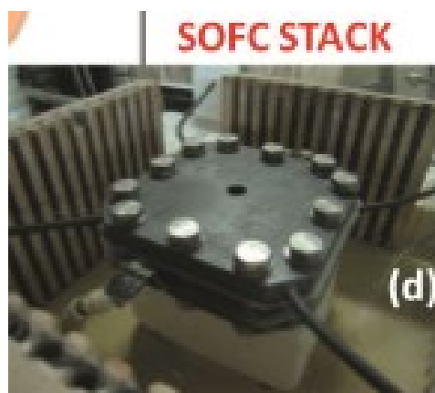
圖十、平板型 SOFC 電池組:(左)爆炸圖;(右)實體圖
