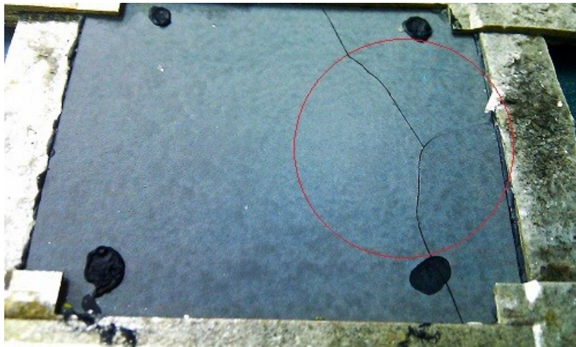
圖二十四、電池平整度不佳致組裝過程發生破裂
