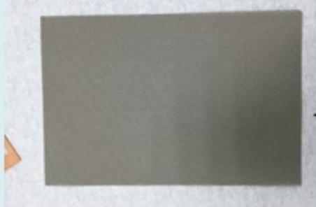
(1) 陽極集電網-發泡鎳 若有發泡銀用於陰極，裁法相同。
