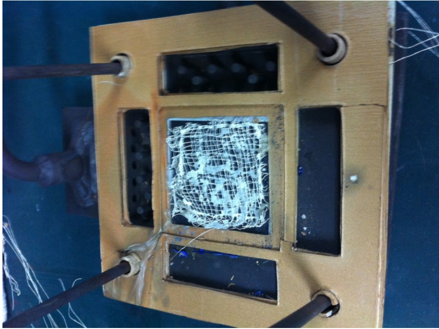
圖五十九、密封材料改善（雲母 + 866）
