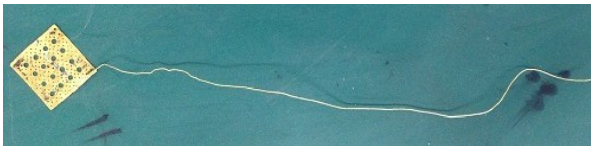
圖五十、黃金導線與黃金集電片結合
