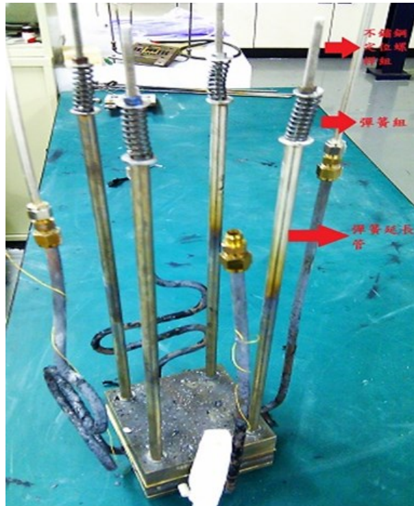
圖五十四、平板式電池組 II 外形結構
