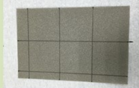
(2) 裁成約4x4cm大小，以及能裝在密封材內(符合電極面積)。
