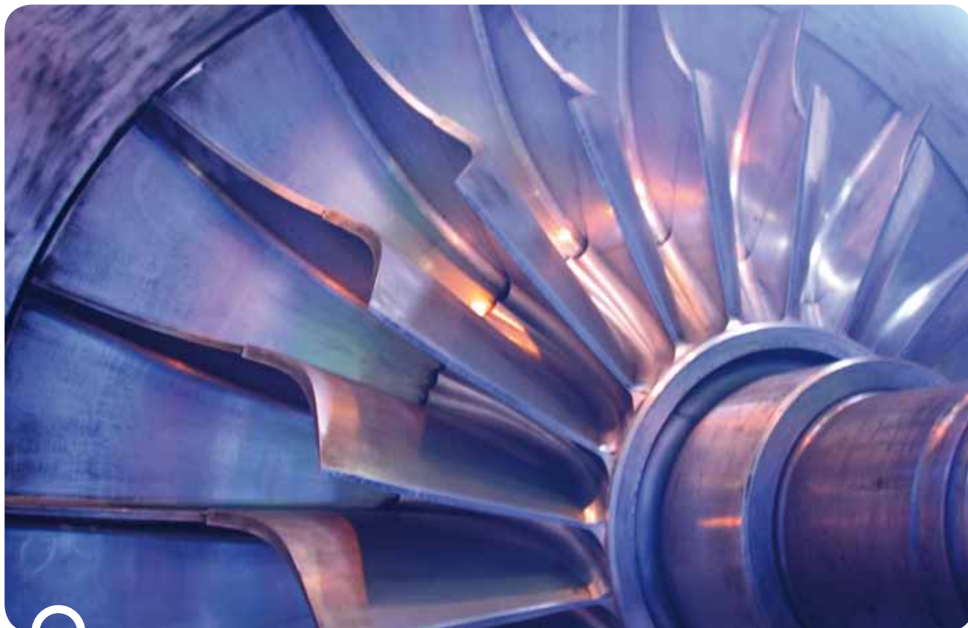
Dettaglio del rotore turbosoffiante di uno dei motori endotermici della Centrale di Mirafiori Nord
