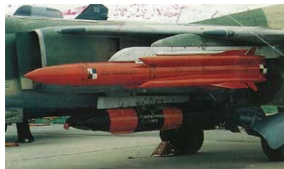
圖24 亦採用衝壓噴射引擎之超高速Kh-31反艦飛彈 中共稱為鷹擊-91（YJ-91），裝配於Su-30 MK2側衛重型戰轟機。（本圖取自Military Technology）
