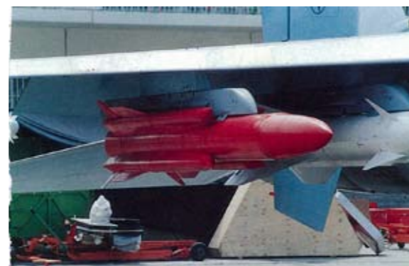
圖25 攜掛於殲轟-7翼下之Kh-31反艦飛彈 Kh-31酷似SS-N-22之攜用大功率衝壓引擎，同樣地亦配置4具小型助推火箭，因為必須先將該飛彈高速射出，然後才能吸入大量空氣與燃油混合經高壓而「做工」，而得以超高速飛行（注意，它不需配置沉重的吸氣風扇以及燃燒室）。（本圖取自Military Technology）
