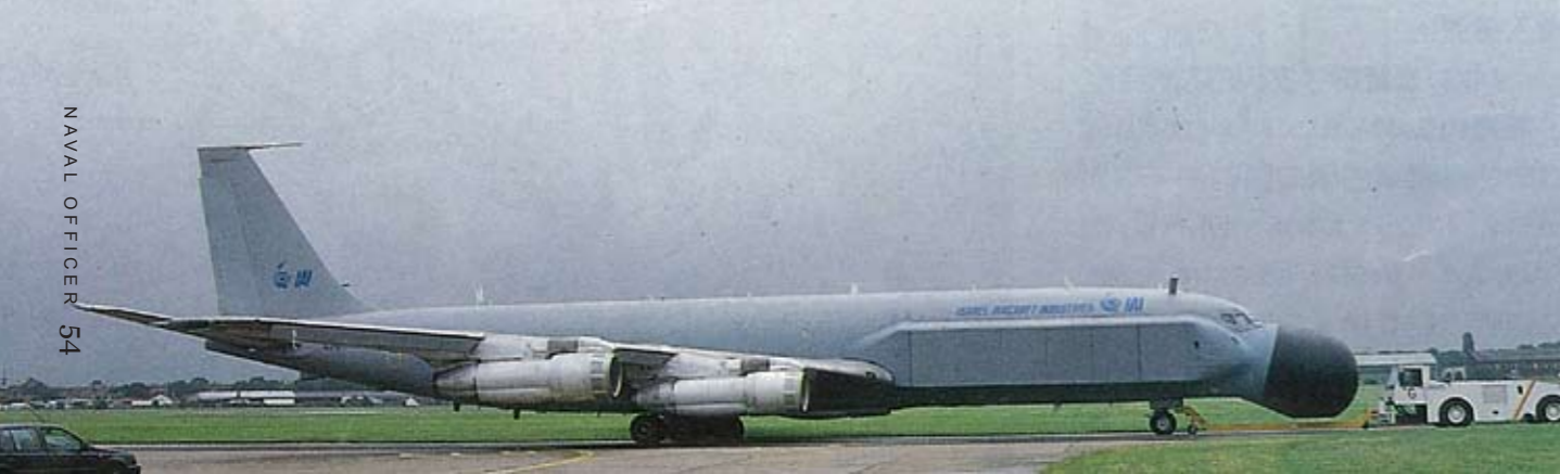
圖29 中共Kh-31P高速反輻射飛彈可打擊空中預警管制機 此為以色列最新型Phalcon預警機，以波音707改裝，加設機身前段各一片長12公尺之相位陣列造形天線，每片天線設有600個發射／接收模組，機鼻亦設相列天線。（本圖取材自Armada雙月刊）
