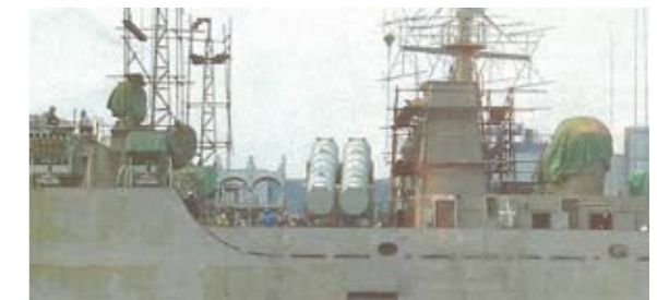
圖17 裝配於中共最新銳052C旅滬級驅逐艦之C-602(鷹擊-62或YJ-62) 可見其雙聯發射座2座，左側之發射座尚未裝上飛彈發射箱。(本圖取用自Military Technology月刊)
