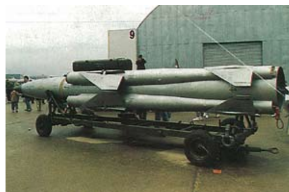
圖23 空射型SS-N-22（型號為Kh-41） 以重型轟炸機攜行出擊，例如Tu-95及Tu-160等。（本圖取自Military Technology）
