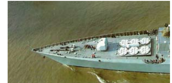
圖19 旅滬級艙段特寫 可見其6座6聯裝HHQ-9防空飛彈垂直發射系統，艙段尚設有4座。並可見其收摺起的吊桿，因此可判其可於海上再裝填飛彈，前面設有使用隱形砲塔之100輕主砲，尚可見其守門員型近接武器系統。(本圖取用自Military Technology月刊)
