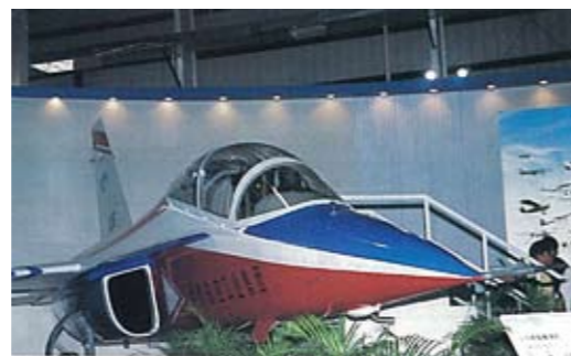
圖4 攜掛TL-10反艦飛彈之中共最新銳L-15先進教練機/輕攻擊機於2006年首次曝光 此為L-15全尺寸模型。該機除了擔任教練機以外，機翼下亦設4個掛點，翼尖亦設有飛彈掛架，可裝掛各型空對地武器或空對空飛彈，作為輕攻擊機使用。L-15採用數位式電傳飛控系統，全長12公尺，翼展9公尺，高4.8公尺，航速高達1.4馬赫，設計壽命10000小時，可使用30年。L-15係抄襲俄羅斯最新銳Yak-130教練機(本圖取自詹氏國際防衛月刊)
