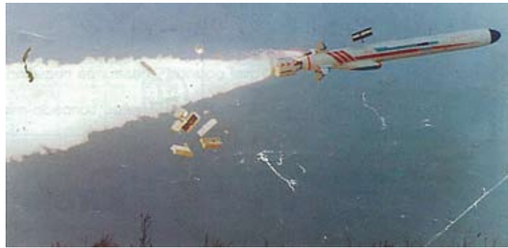
圖14 中共新世代最顯眼的C-602勁射起飛特寫 該大量部署於最新銳戰艦之C-602使用固體燃料 助推器發射，然後啟動渦輪噴射引擎接手持續高 速進襲，注意其拋棄的破碎的助推器。其射程遠 達280公里；其腹部設大型進氣口。(本圖片取自 詹氏國際海軍雙月刊2007年1/2月版)
