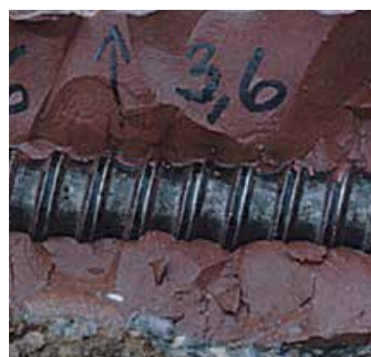
Разрез извлеченной из грунта анкерной сваи ТИТАН 30/11
