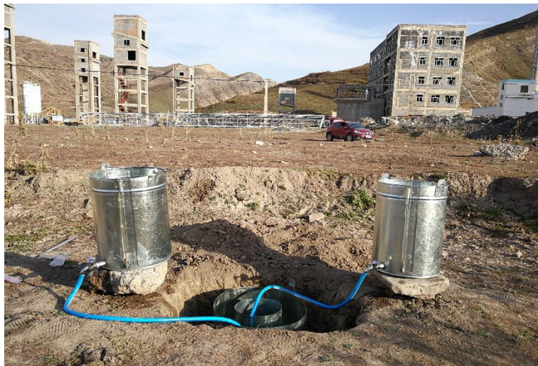
图 5-4-3 工业场地双环法渗水试验
