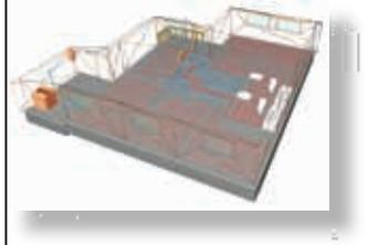
El principio básico del sistema de calefacción y refrigeración mediante superficies radiantes, consiste en la impulsión de agua a media temperatura (en torno a los 40°C en invierno y a los 16°C en verano) a través de circuitos de tuberías plásticas fabricadas principalmente en polietileno.
