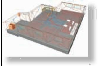
Para limitar el flujo de calor a través del suelo de las habitaciones situadas inmediatamente debajo, la resistencia térmica de la capa de aislamiento  $R_{\lambda, ins}$  debe de estar al menos de acuerdo con tabla:
