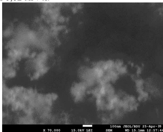
Рис. 1. СЭМ-изображения образцов наночастиц никеля, стабилизированных полиакриловой кислотой, представлены в лупах (70 000) в медленном электронном режиме при напряжении 15 кЭв.
