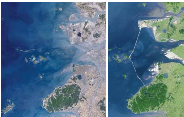
방조제 공사가 시작되기 전 1989년 5월 우주에서 본 새만금과 2006년 10월 방조제가 막힌 후(사진: 미항공우주국 웹 제공) Saemangeum seen from space in May 1989, before the start of construction, and again in October 2006, after seawall closure (NASA).
