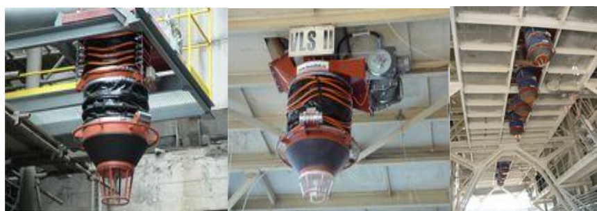
Рисунок 8. – Загрузочные устройства HENNLICH. NZU - телескопическое загрузочное устройство для закрытой загрузки
