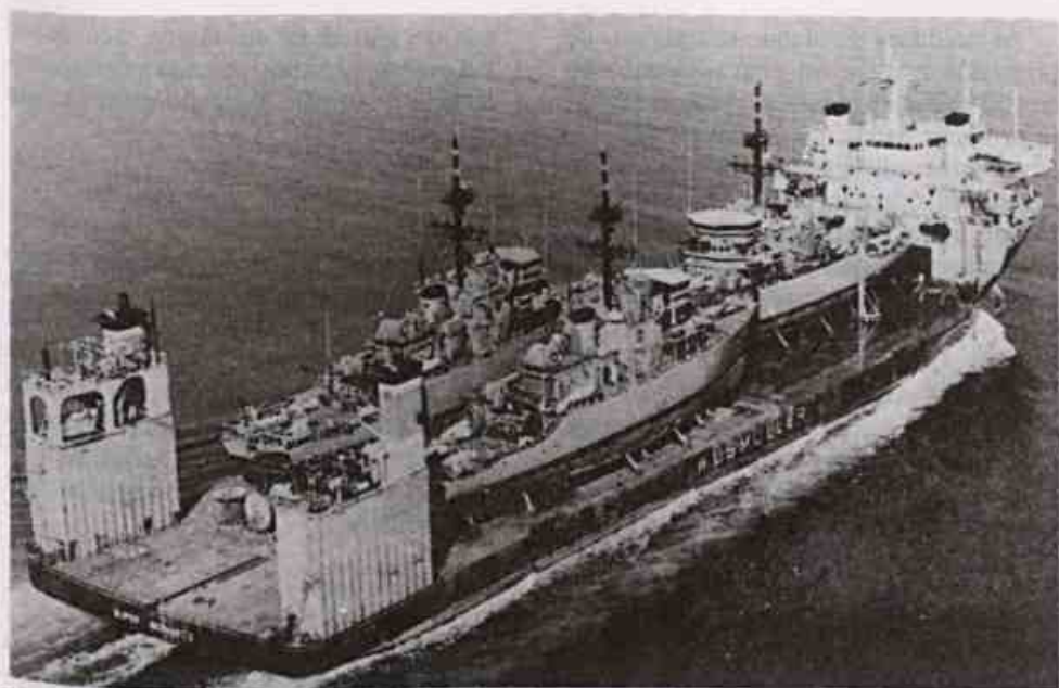
Fig. 1 — O navio semi-submersível Super Servant Three navega para o Golfo Pérsico, transportando três navios-varredores classe Acme/Agressivo , norte-americanos
