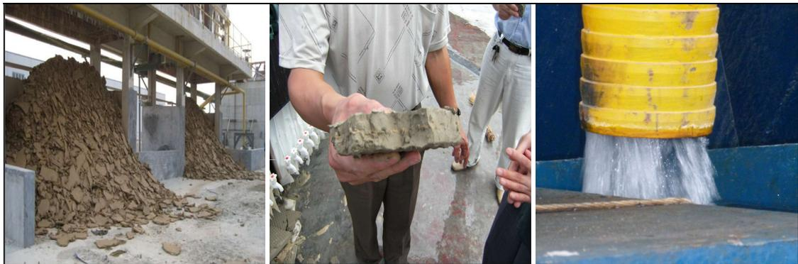
图 2.3-5 经过压滤干化系统处理的渣土和水
