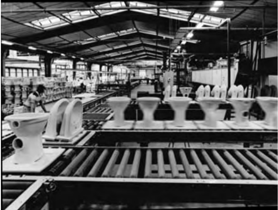
De logistieke afhandeling van het sanitair. De producten worden hier volautomatisch gesorteerd en door middel van een transportrollensysteem op plaats van bestemming gebracht. Omstreeks 1990. Coll. SHCL
