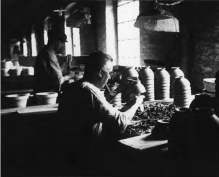
Toepassing van een 'jolly' voor de vorming van de binnenkant van holle producten zoals deze spoelkom. Sphinx 1930. Coll. SHCL
