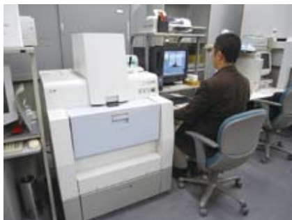
蛍光X線分析による材質調査の様子 X-ray fluorescence analysis of materials
