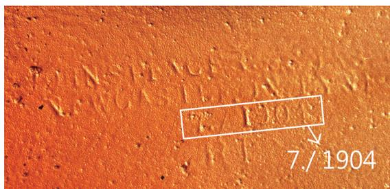
圖 12. BK24 右後動輪輪盤上的銘文，本照片經軟體調整過明暗曲線
