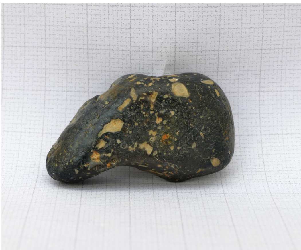
Pěkný vzorek silicitu s obroušenými tvrdoši - světlé barvy. Na povrchu jsou viditelné nárazové trhliny jako u příbojových oblázků - původně to mohl být křídový pazourek. Leg. + Foto: F.Scholz.
