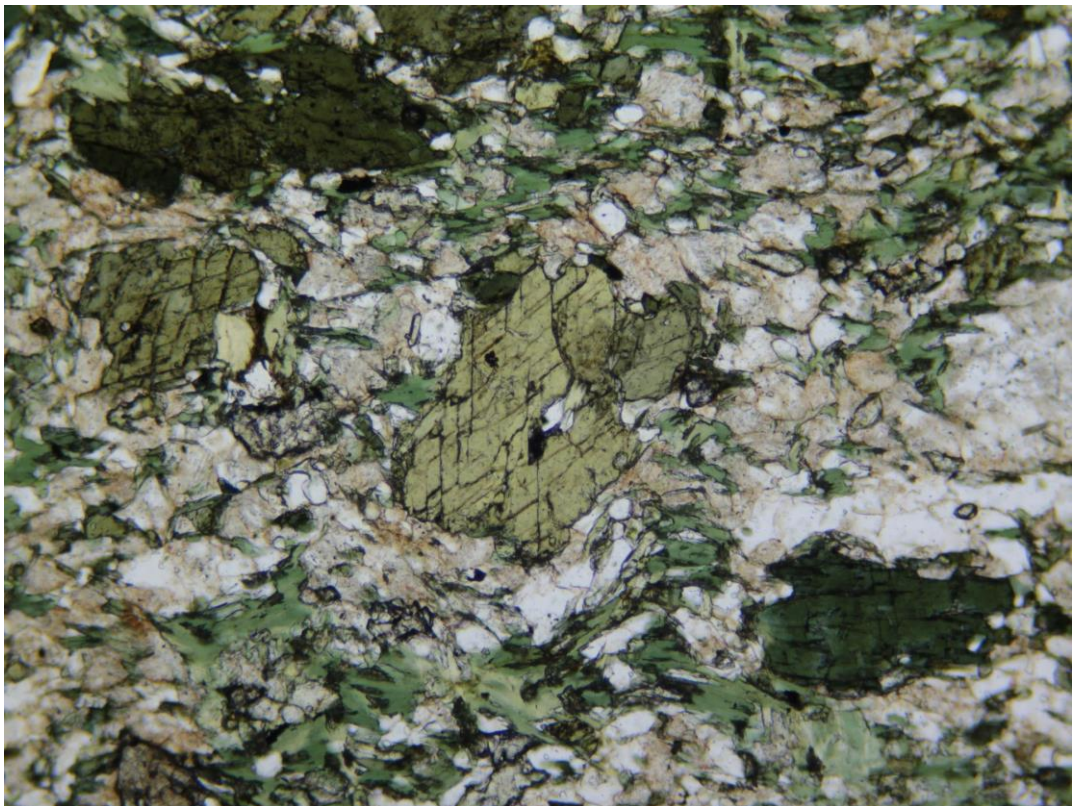
Zvětšení 100x PPL. Amfibol a chlorit. Foto: A. Vančura, 2021.
