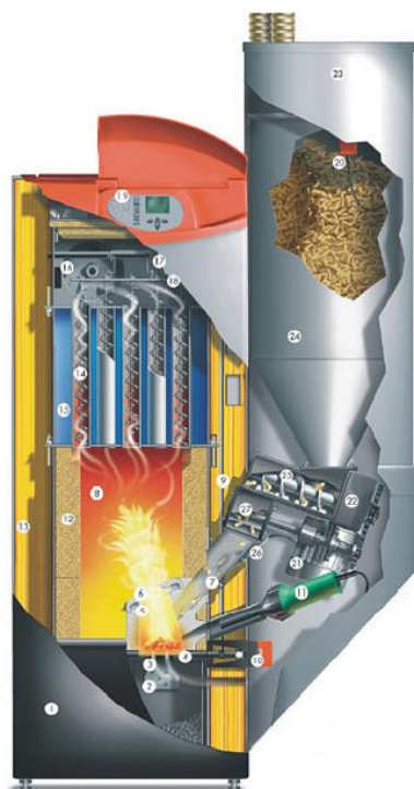
Obrázek 14: Automatický kotel na pelety se zásobníkem Guntamatic Biostar [38]
