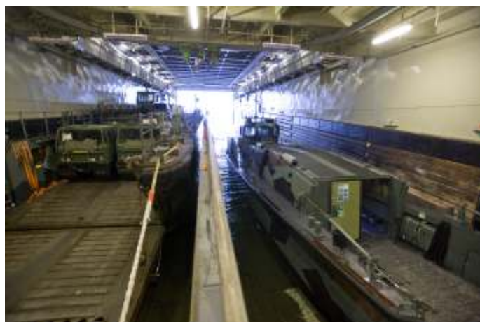
De 12kN Navy van Iveco bleek te groot voor een LCVP rechts. Op de LCU links past hij wel.
