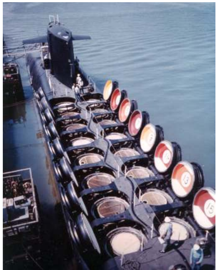
Lanceerinstallaties voor Polarisraketten op de USS Sam Rayburn (SSBN-635). Enkele van de duizenden overdrachtssystemen voor kernwapens. Foto: US Navy Naval History and Heritage Command
