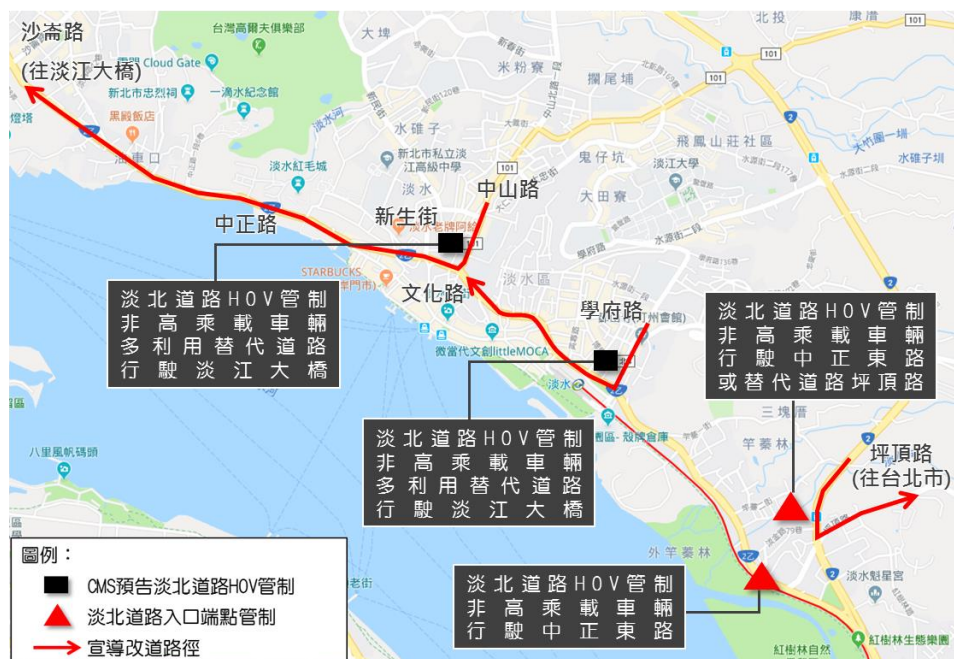
圖 5.2-15 淡北道路高乘載管制 CMS 設置位置及導引資訊
