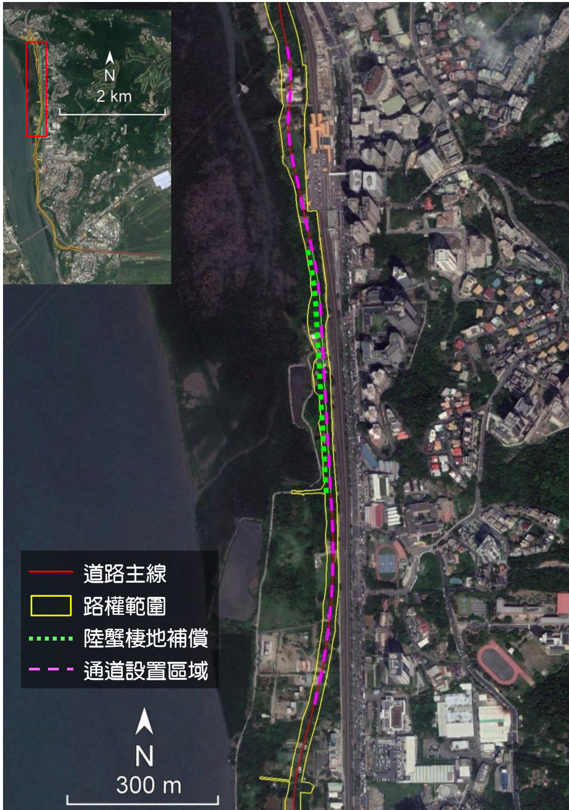
圖 5.1.1-10 蟹類棲地補償與通道設置示意
