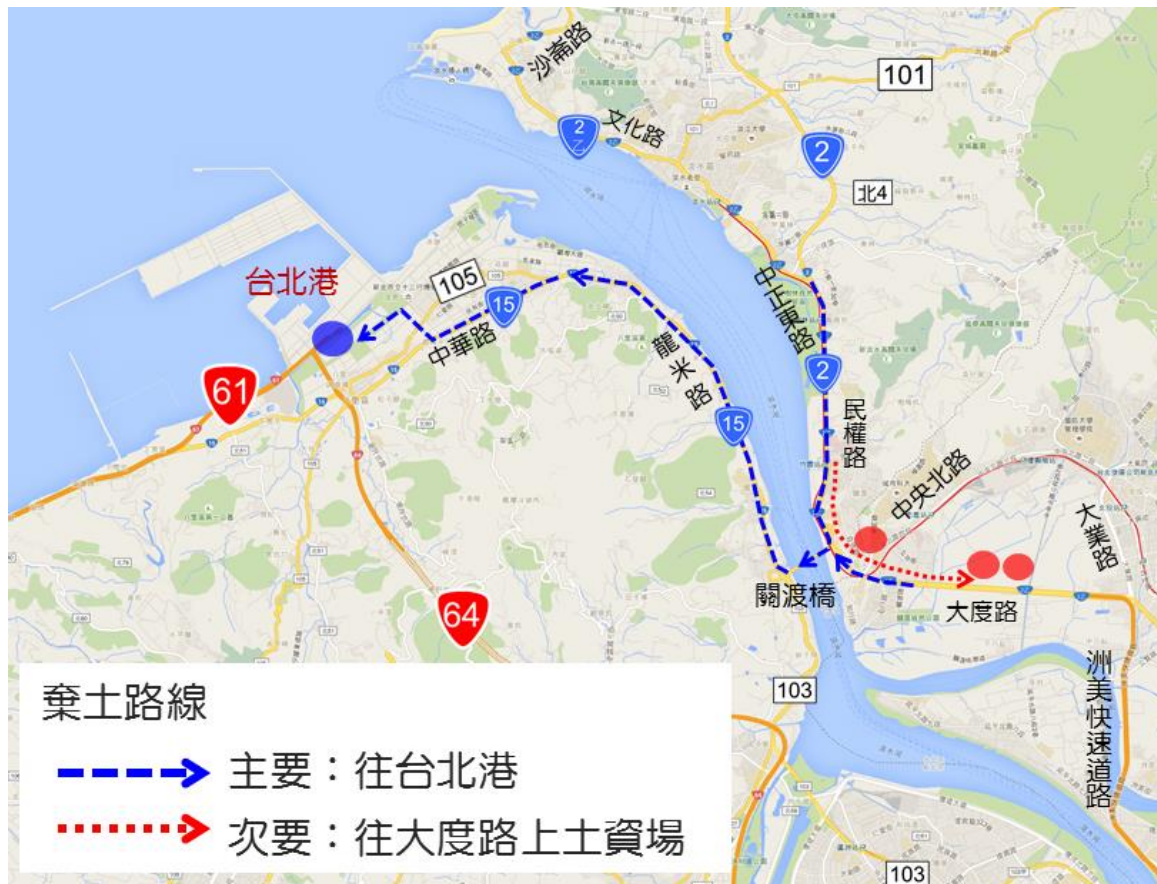
圖 4.2.4-1 計畫道路鄰近土方處理場所及土方運輸路線示意
