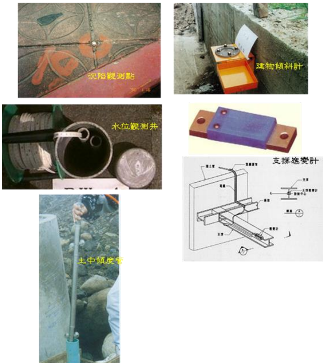
圖 6.3.2-1 施工中各類安全監測儀器示意圖
