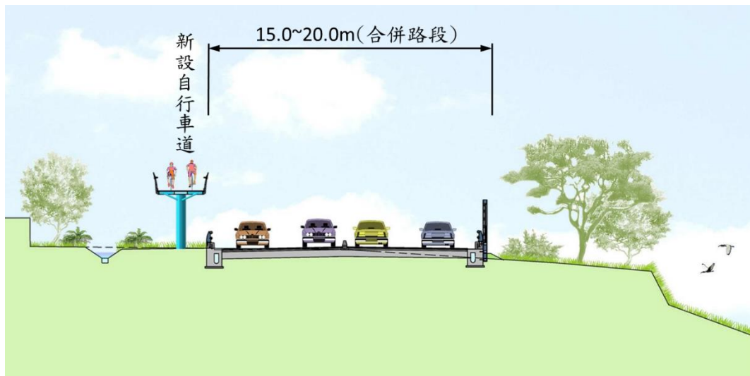
路堤段標準斷面 (含新設自行車道) (斷面 G)
