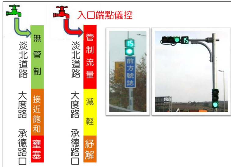
圖 5.2-13 淡北道路入口端(新北市端)儀控調節車流示意圖
