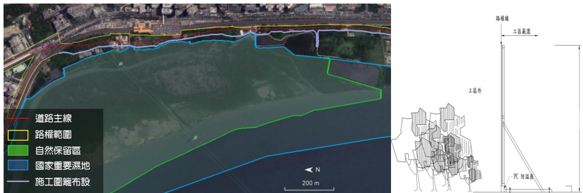
圖 5.1.2-4 施工圍籬布設位置與橫斷面示意
