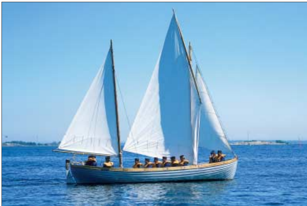
Valbåt riggad med två master, stagesegel, loggertsegel och trekantssegel
