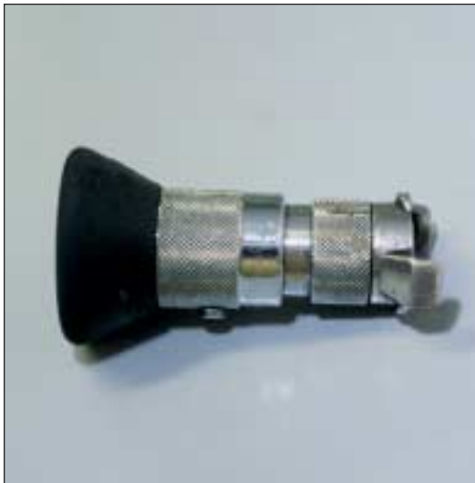
Släckmunstycke Fog-Jet används för brandbekämpning och kylning av brandgränser.
