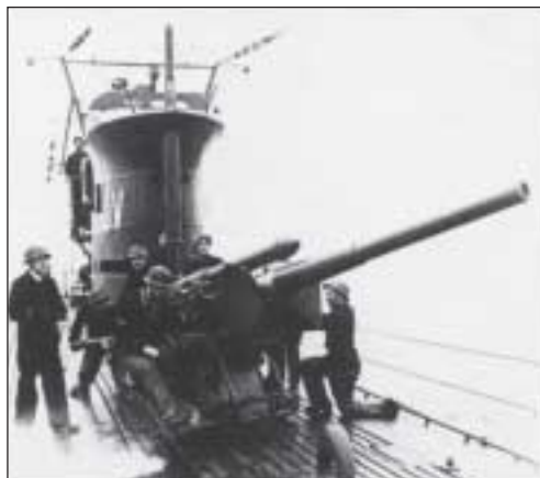
Ubåtarna Draken , Gripen och Ulven byggdes omkring år 1930. De hade 670 tons displacement och var bestyckade med fyra 53 cm torpedtuber samt en 25 mm kanon och en 10,5 cm kanon. Bilden visar Ulven som blev sänkt 1943 efter att ha gått på en tysk mina på svenskt territorialhav.
