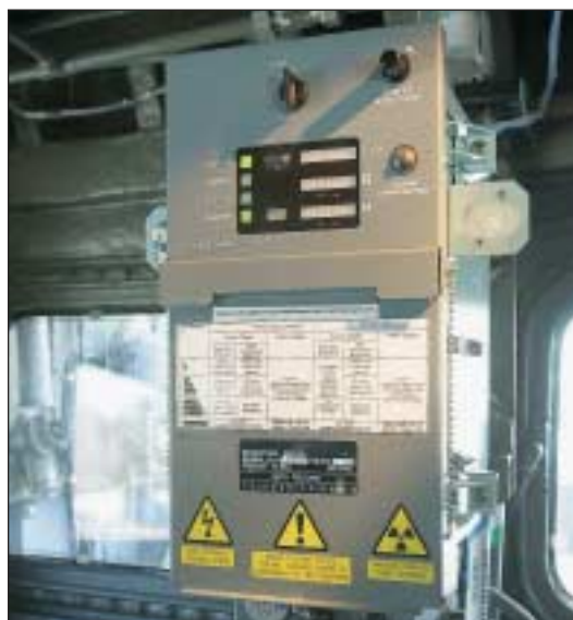
GID 2A är ett fast monterat C-varningsinstrument
