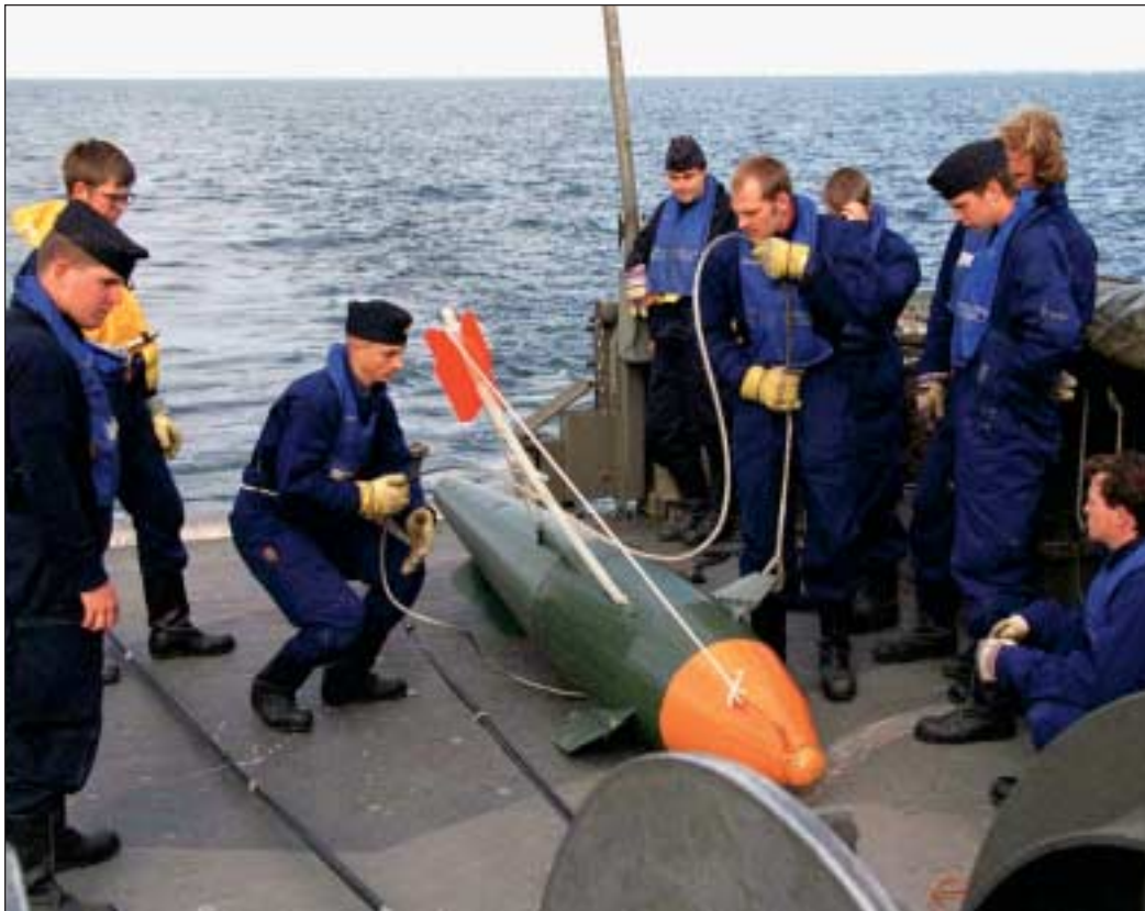
En svepboj bärgas ombord på minröjningsfartyget Landsort
