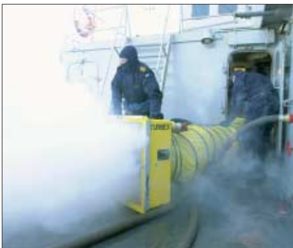
Sugfläktar används för undertrycksevakuering av rök
