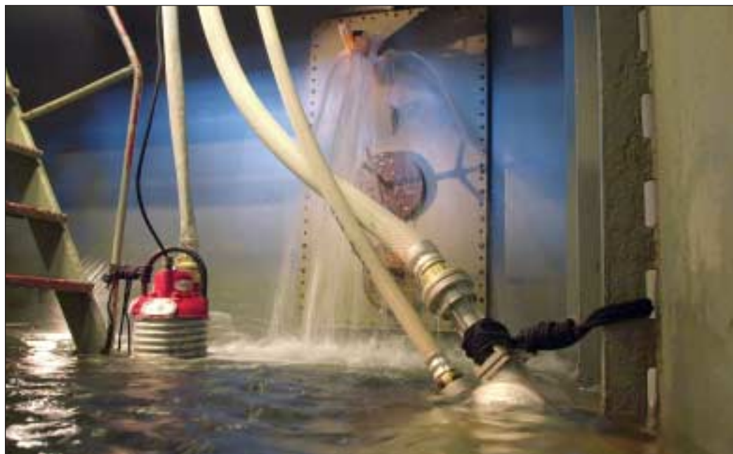
Länsning kan, tillsammans med tätning, minimera en vatteninträning
