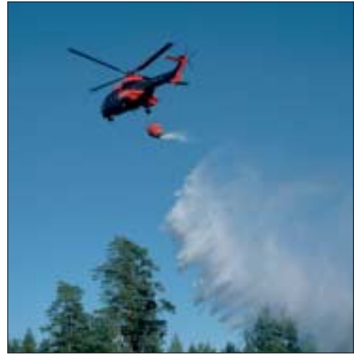
Hkp 10 med vattentunna för brandsläckning
