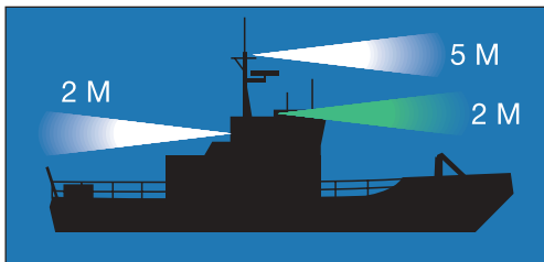
Regel 23 a: Fartygsljusens lysvidd på fartyg mellan 20 och 50 meters längd
