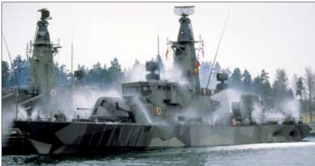
Fartygets sprinklersystem kan användas i förebyggande syfte.
