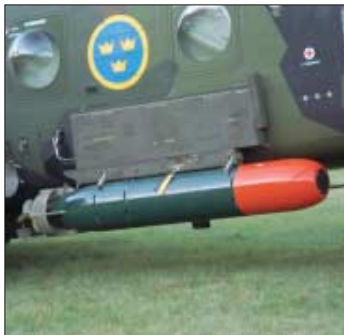
40 cm ubåtsjakttorped upphängd på en hkp 4
