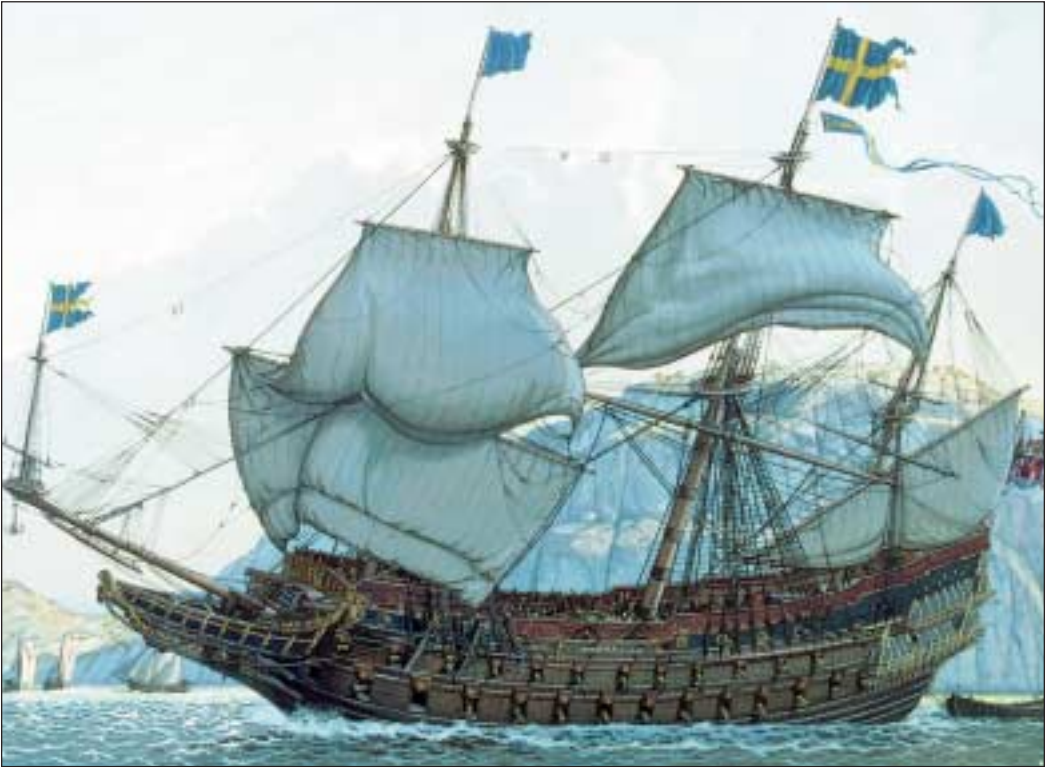
Regalskeppet Vasa hade ett displacement på 1.200 ton och var bestyckat med 48 st 24-pundiga kanoner
