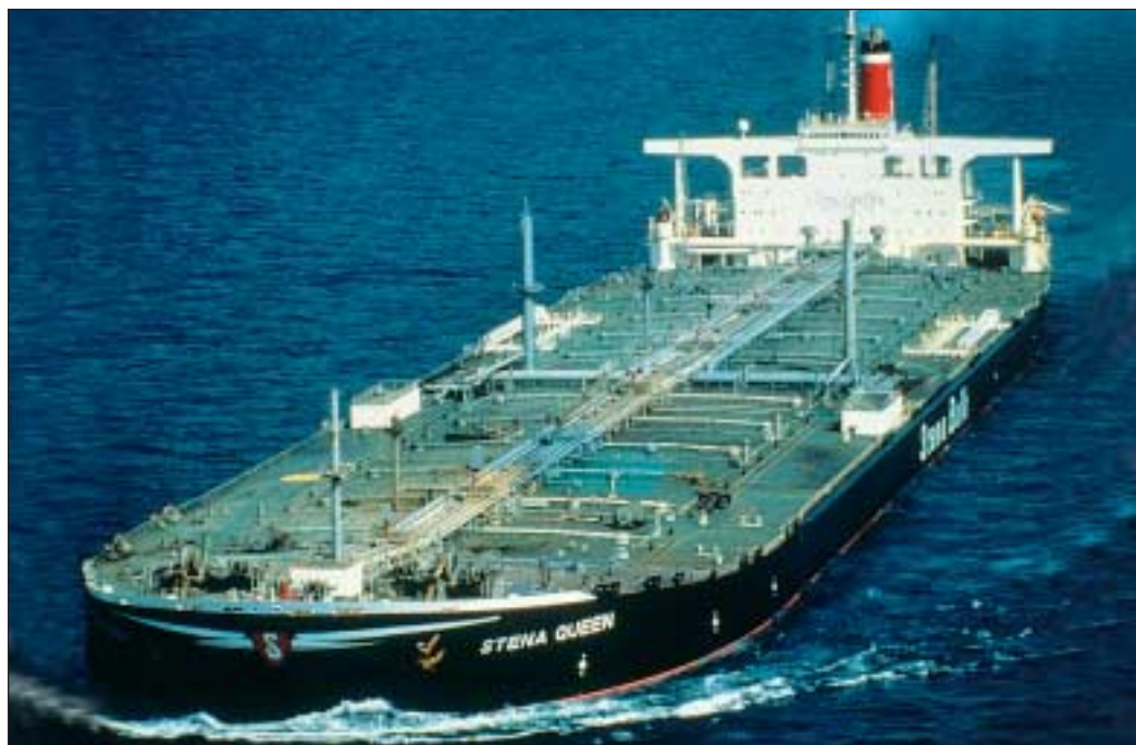
Tankfartyget Stena Queen på 457.000 tons dödvikt. Längd 378 m, bredd 68 m.
