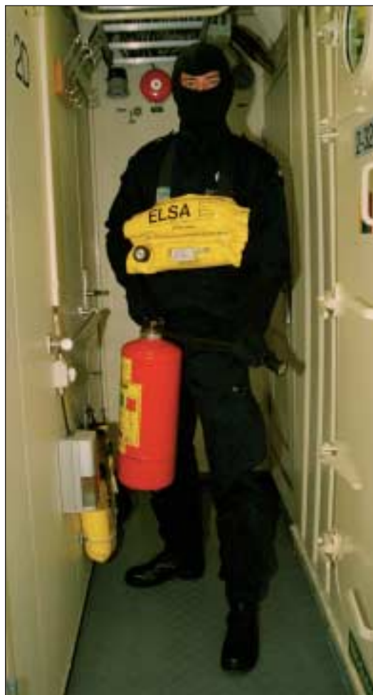
Flykthuva ELSA bärs fastspänd på bröstet av fartygets första insatsgrupp
