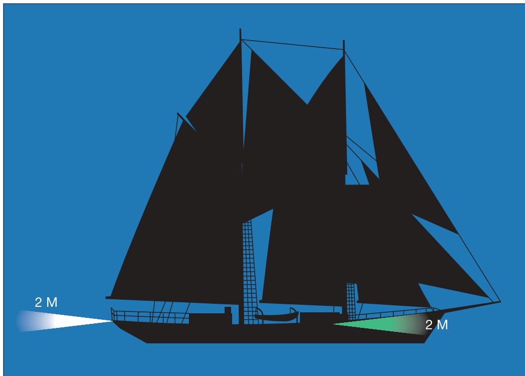
Regel 25: Fartygsljusens räckvidd på segelfartyg med en längd av 12 meter eller mer.
