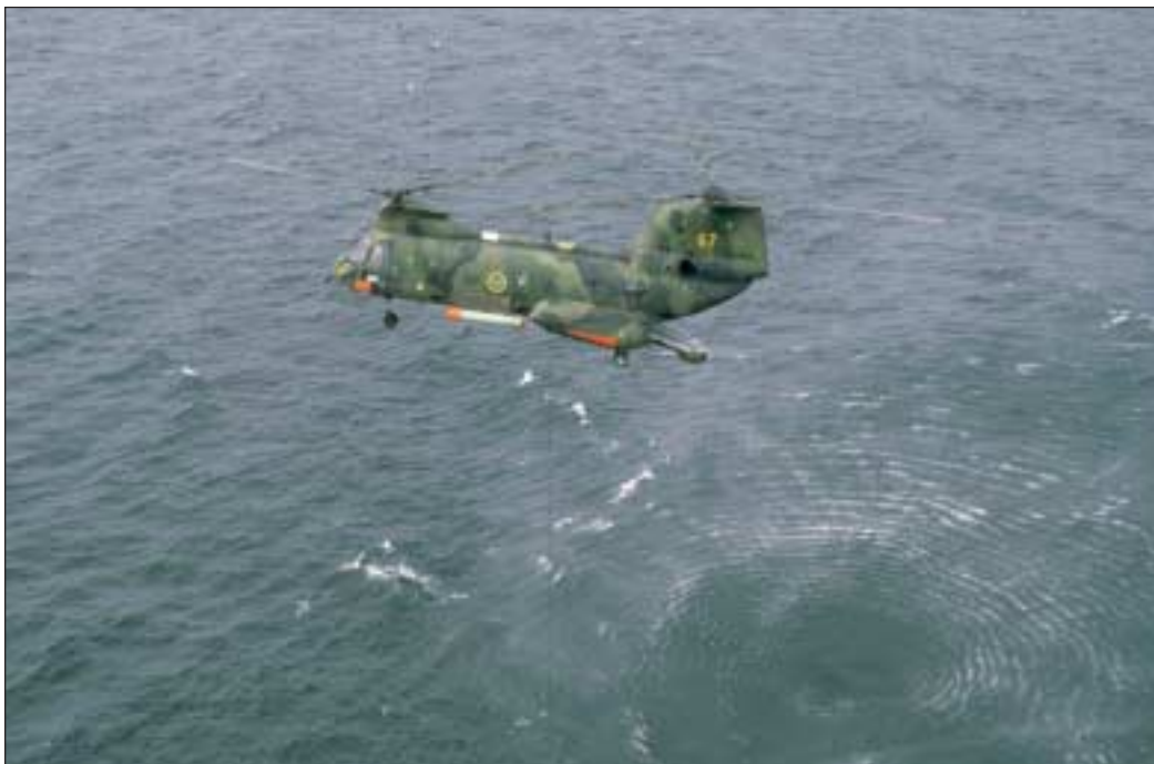
En torpedlastad Hkp 4 med nedsänkt sonar under ubåtsjaktövning
