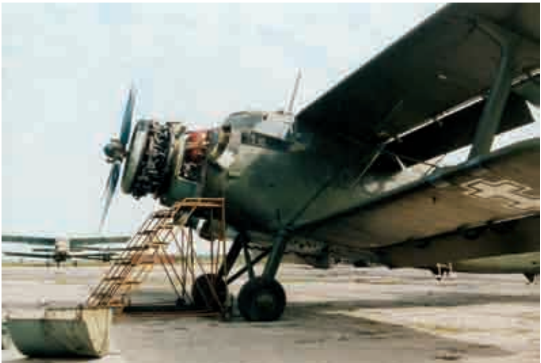
Transporto lėktuvo An-2 variklio techninis aptarnavimas. Barysiai, 1995 m.
