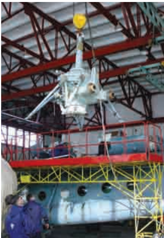
Sraigasparnio pagrindinių agregatų keitimas KOP Ginkluotės ir technikos remonto depe
