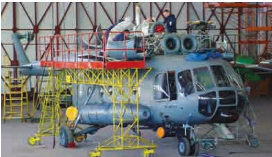
Sraigatarnio pagrindinių agregatų keitimas KOP Ginkluotės ir technikos remonto depa
