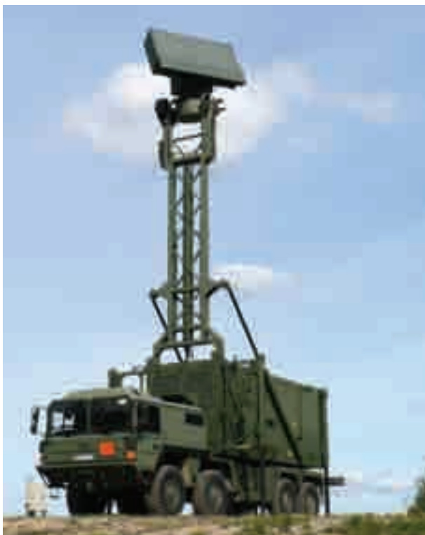
Mobili vidutinio nuotolio trijų dimensijų radarų sistema TRML-3D/32. Pagamintos 2004 m. Vokietijos Federacinėje Respublikoje. Maksimalus taikinio aptikimo nuotolis – 150 km. Signalų apdorojimas skaitmeninis. Išskleidžiama per 25 min. Sunaudojamos elektros energijos galingumas 30 kW. Montuojama sunkvežimyje MAN-32410. Aptarnauja 2 asmenys. KOP 2004 m. Vokietijoje įsigijo tris šio tipo sistemas
