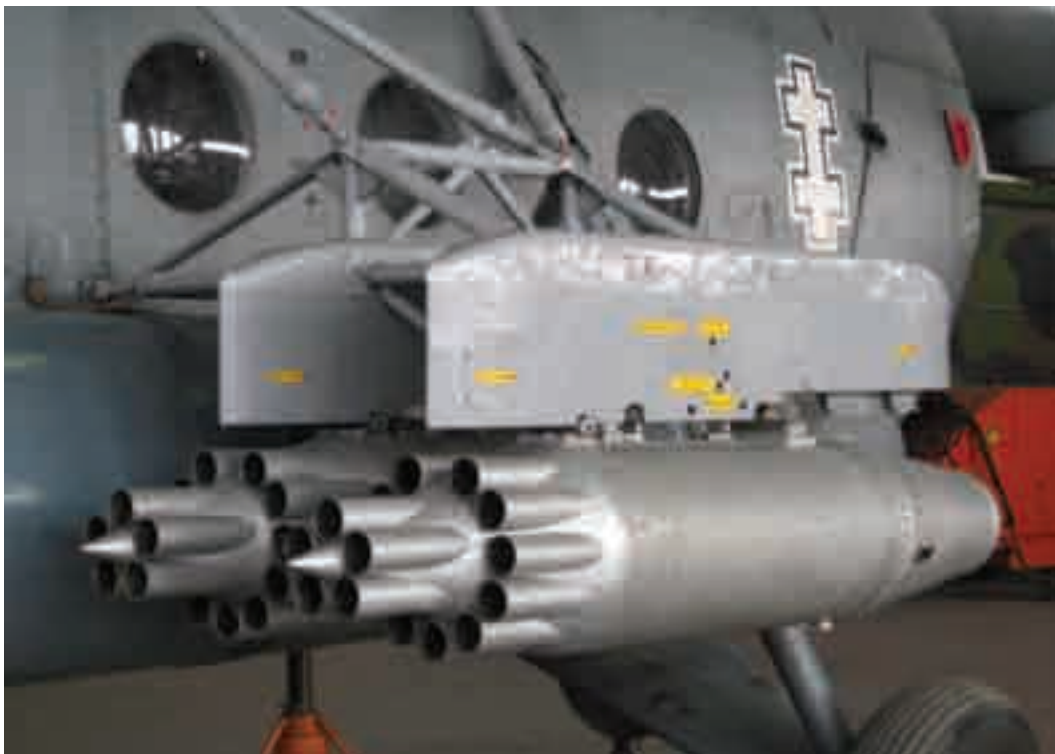
Prie sraigtasparnio Mi-8T tvirtinami nevaldomų raketų paleidimo įtaisai
