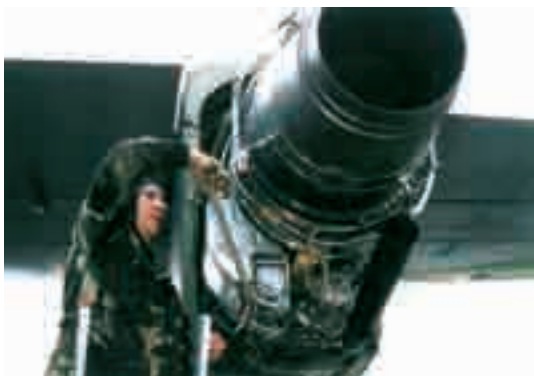
Lėktuvo An-26 variklio techninė apžiūra. Zokniai, 2001 m.
