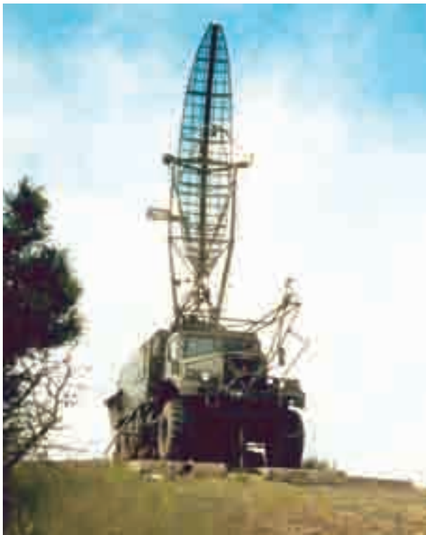
Transportabilus tolino veikimo aukštimitis PRV-11. Pagamintas 1971 m. SSSR. Nustato nuotolį iki taikinio, aukštį ir azimutą. Maksimalus taikinio aptikimo nuotolis – iki 170 km. Išskleidžiamas per 3 h. Sunaudojamos elektros energijos galingumas – 30 kW. Montuojamas dvejose automobilinėse priekabose. Aptarnauja 7 asmenys. KOP eksploatavo vieną šio tipo aukštimitį
