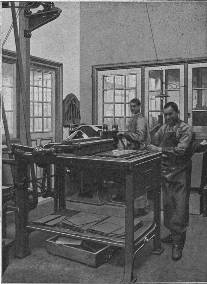
Hydraulische pers en grafiteer-machine in de galvanoplastische inrichting der Lettergieterij „Amsterdam.”
