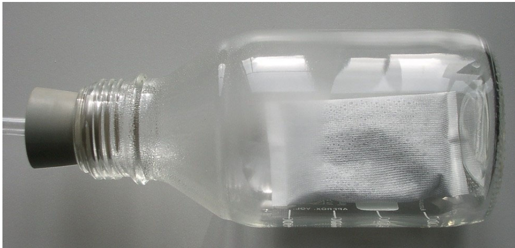
Abbildung 5: Wasserbildung bei der Reaktion eines Beutels in einer Flasche mit reiner Sauerstoffatmosphäre
