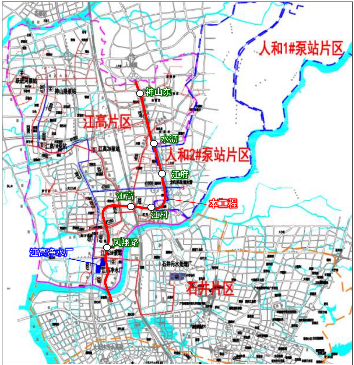
图 7.4-1 江高净水厂服务范围及管网敷设图
