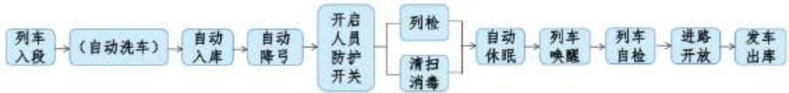
图2.1-26 车辆运用工艺流程图
