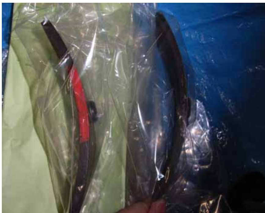
事故機（5号機：右側）のブレーキライニングの厚み：約6 mm 隣接機（4号機：左側）のブレーキライニングの厚み：約7.6 mm
