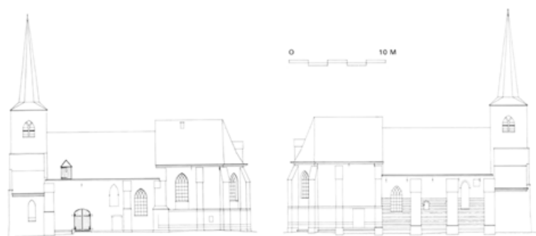
Afb. 175. Hervormde kerk. Opmetingstekening van de noord- en zuidgevel na de ontleistering in 1975. Tekening naar opmeting van het architectenbureau W.A. Heineman, Velp.
