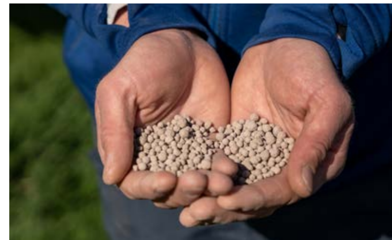
Põlevkivituha graanulite testpartii toodeti keemilise ja bioloogilise füüsika instituudi (KBFI) laboris. Nii sai tõestatud, et põlevkivituha on võimalik granuleerida vastavalt põllumajandussektori nõuetele.
