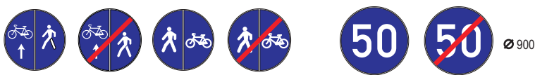
419 Gājēju un velosipēdu ceļš 420 Gājēju un velosipēdu ceļa beigas 421 Gājēju un velosipēdu ceļš 422 Gājēju un velosipēdu ceļa beigas 423 Minimālā ātruma ierobežojums 424 Minimālā ātruma ierobežojuma beigas
