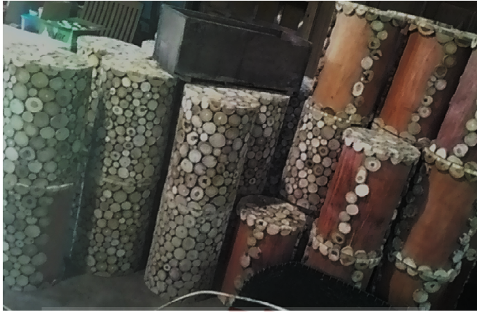
Gambar 64.: Hasil tempelan ranting dengan lem kayu dan dilakukan secara bertahap sambil menunggu cukup lem kering.
