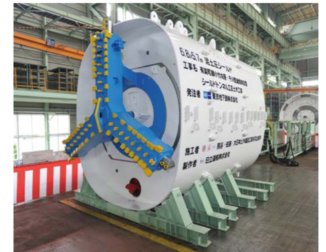
2014年 東京都 東京メトロ有楽町線 小竹向原～千川間 施主 東京メトロ(株)殿 施工 (株)熊谷組殿 マシン外径 5.7m×6.8m 掘削距離 175m/145m 特長 複合円形 (円形カッター+伸縮スポーク)
