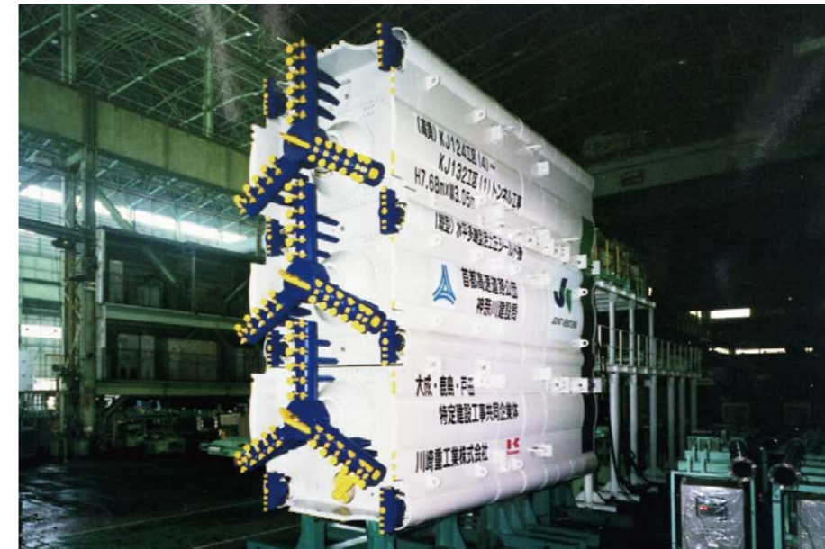
2002年 神奈川県 (高負)KJ124(4)～KJ132(1) トンネル工事 施主 首都高速公団殿 施工 大成・鹿島・戸田JV殿 マシン外径 7.68m×3.05m 掘削距離 1,080m
