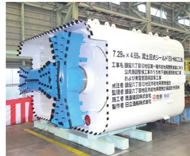
2016年 東京都 銀座六丁目10地区第一種市街地再開発事業に伴う公共施設整備工事のうち 地下連絡通路整備工事および東電管路移設等工事 施主 銀座六丁目10地区市街地再開発組合殿 施工 鹿島建設(株)殿 マシン外径 7.29m×4.69m 掘削距離 103m 特長 横長矩形断面を掘削するためカッターヘッドを2基、矩形のコーナー部の切削のため、伸縮カッターを2基装備。フードを取付けたため伸縮カッターとの干渉を電氣的に制御している。最低土被り2.6m。
