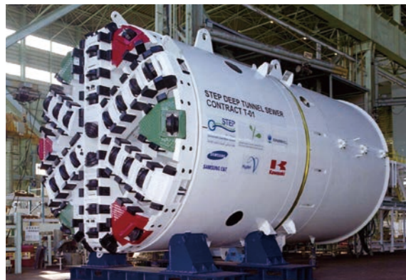
Φ5.22m泥土圧シールド [アラブ首長国連邦]
