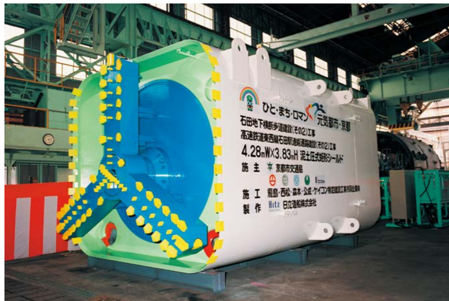
2002年 京都府 高速鉄道東西線石田駅連絡通路建設 (その2)工事 施主 京都市交通局殿 施工 飛島・西松・森本・公成・ケイコンJV殿 マシン外径 4.28m×3.83m 掘削距離 142m 特長 矩形(OHM)
