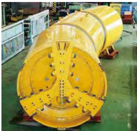
コンパクトシールド工法で使用する密閉型シールド機とセグメント搬送作業の様子
