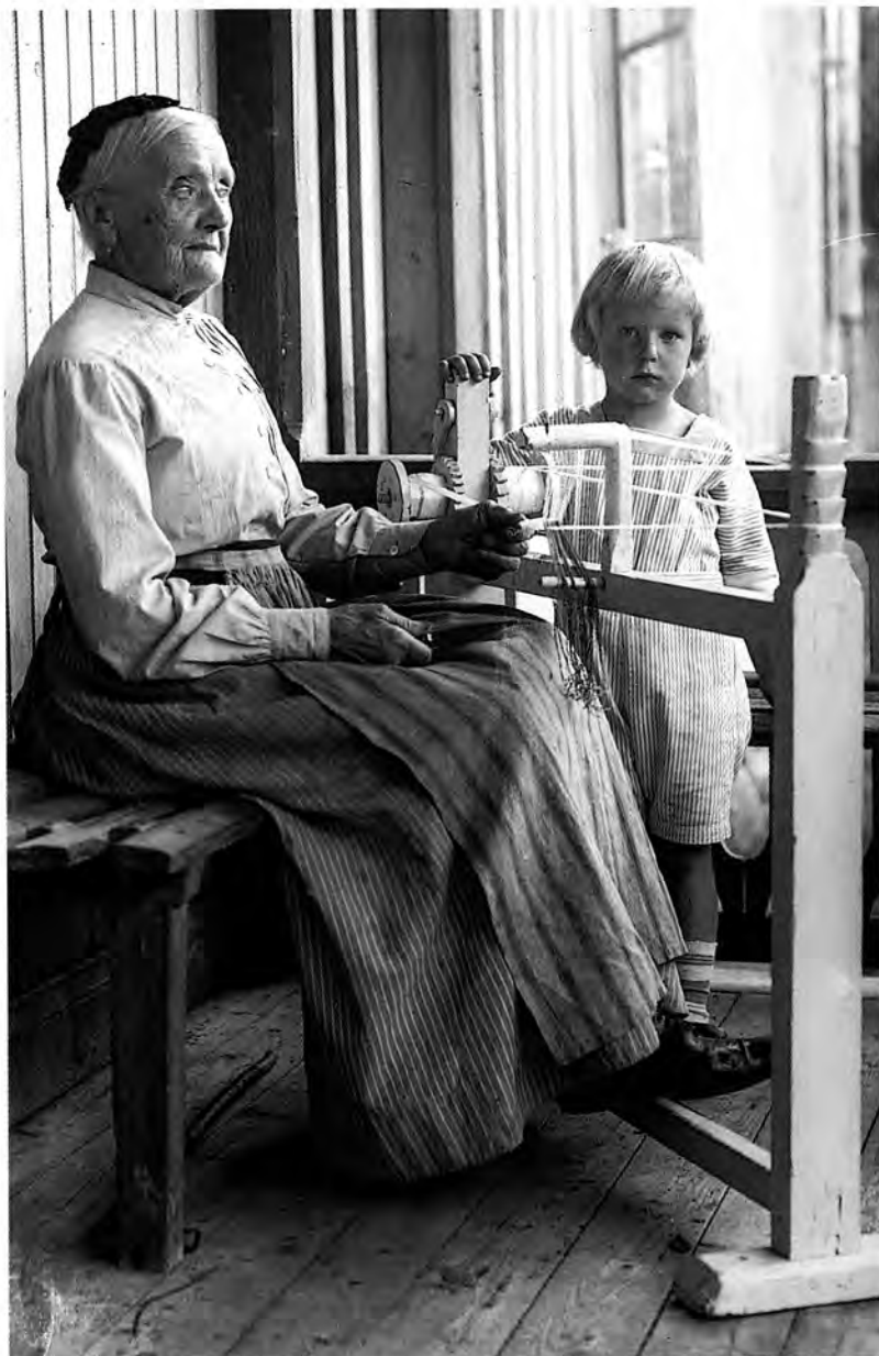
Vävning på en bandvävstol. I svenskt dräktskick förekom de vävda banden till förkläden och hängslen eller som livband, pälsband eller skoband med mera. Bilden från Nordmaling i början av 1900-talet.
