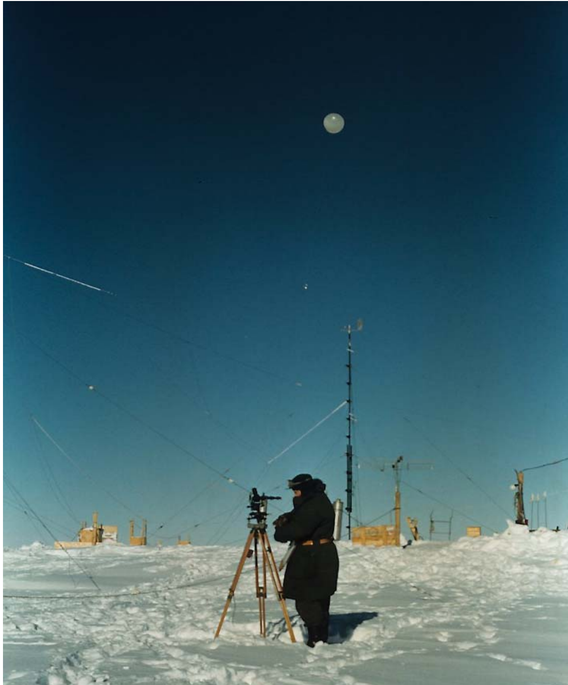
Her slippes en radiosonde. Ballongen følges optisk så lenge som mulig i godvær. I tillegg kunne de følge radiosonden ved hjelp av instrumenter.
