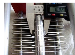
Trägerstangen aus Vollmaterial (keine Gewindestangen), bis zu 16mm dicke Abstandsrollchen und 1,2mm dicke Platten sind die Grundlage für einen starkstrom- / hochspannungsfesten Kondensator.
