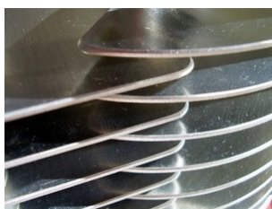
Lasergeschnittene und handentgradete Kanten sorgen für eine hohe Spannungsfestigkeit.
