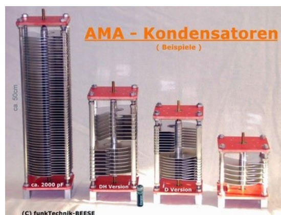
Lasergeschnittene und handentgradete Kanten sorgen für eine hohe Spannungsfestigkeit.
