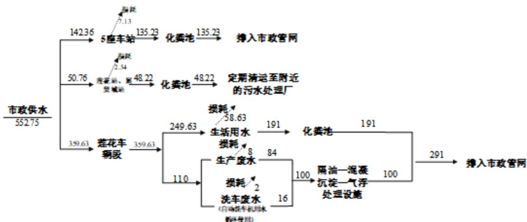
图 4.2-3 站、段水平衡图 ( $m^3/d$ )
