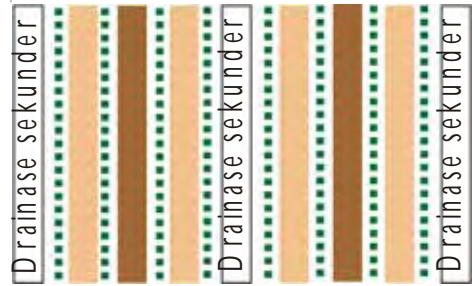
Gambar a. Penimbunan pada sistem 1 drainase pada setiap 4 baris
