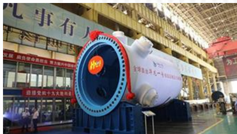
压力容器 Reactor vessel
