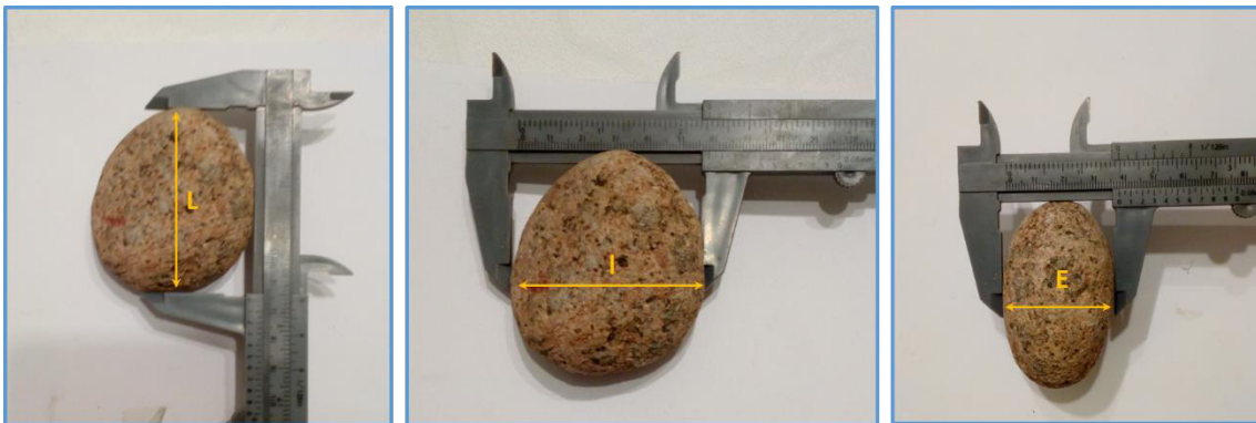
Figura 65. Medição do comprimento (L), da largura (I) e da espessura (E) de um clasto.
