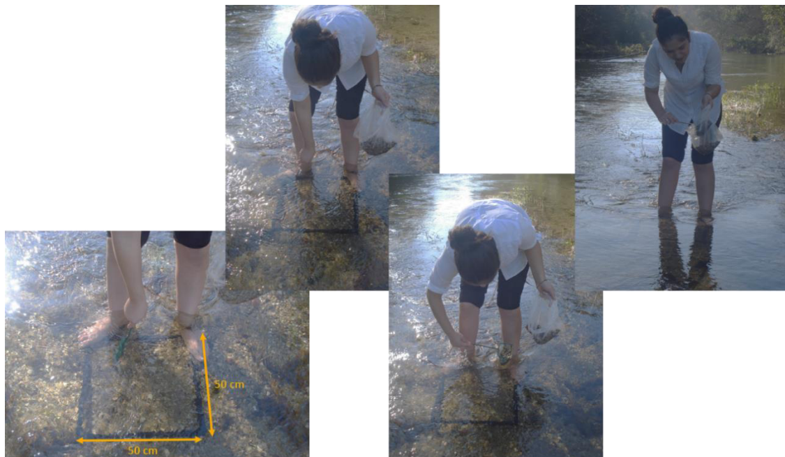
Figura 55. Metodologia adotada na recolha de sedimentos utilizando um caixilho quadrangular de modo a definir a área amostrada.
