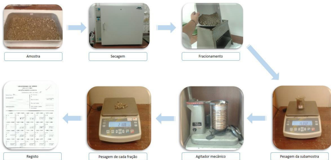
Figura 69. Esquema representativo da metodologia adotada, na etapa laboratorial, para obtenção e subsequente análise dimensional por crivação numa coluna de crivos no Ro-Tap, numa amostra com fração < 62 \mu m vestigial.
