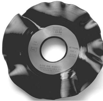
Gambar 1.12. Media Rekam Piringan Hitam yang Mengkerut karena Suhu Tinggi
