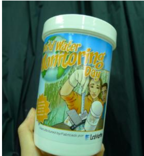
圖 15、簡易檢測包(WWMD test kits, LaMotte)
